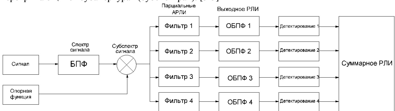
Рис. 1. Структурная схема внутриэлементного некогерентного накопления
