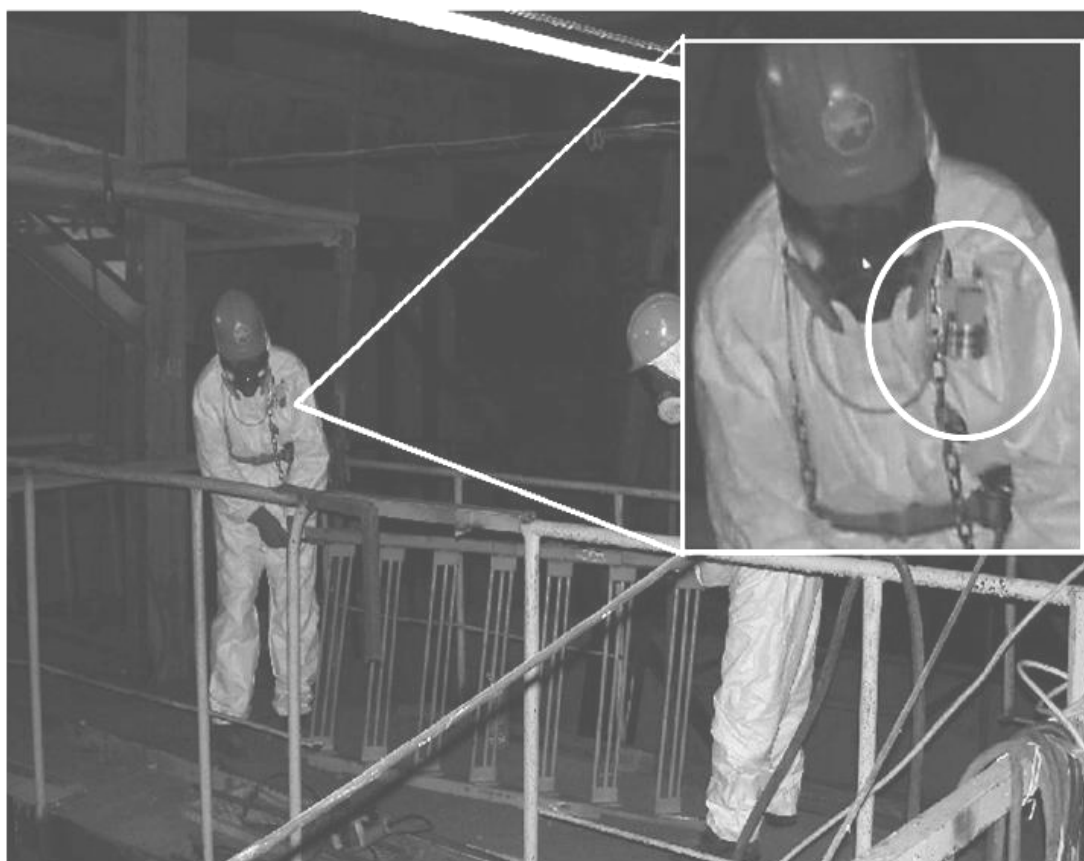
Рис. 4. Проведення пробовідбору за допомогою персонального імпактору під час виконання робіт на ОУ. Приміщення – 635/3 відм. + 24, Тип робіт – 2
