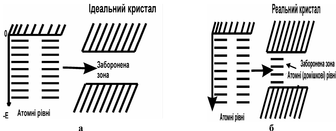
Рис.1. Схема утворення енергетичної структури у випадку ідеального (а) та реального (б) кристалів.
