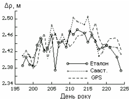
Рис.1. Атмосферні поправки у відстань в проміжку 30 днів на час UT=12^h , отримані в 2004р. для п.Київ трьома методами.
