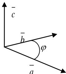
Вектор  $\bar{c}$  називається *векторним добутком* двох векторів  $\bar{a}$  і  $\bar{b}$ , якщо він задовільняє умови:
