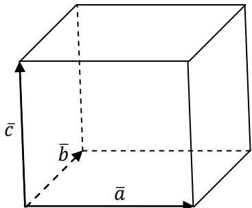
Мішаним добутком трьох векторів  $\bar{a}$ ,  $\bar{b}$  і  $\bar{c}$  називається число, яке визначається як скалярний добуток вектора  $\bar{a}$  на векторний добуток  $\bar{b} \times \bar{c}$ , і позначається  $\bar{a} \bar{b} \bar{c} = \bar{a}(\bar{b} \times \bar{c}) = (\bar{a} \times \bar{b}) \bar{c}$ .
