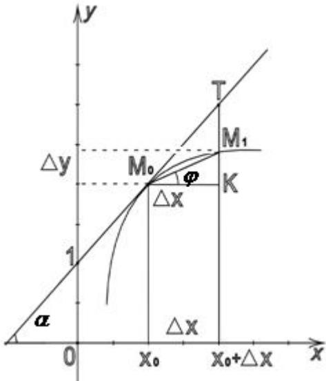
Тобто, значення похідної функції в точці  $x_0$  дорівнює тангенсу кута, що утворює дотична, проведена до кривої в цій точці з додатнім напрямом осі  $Ox$ . Це і є геометричний зміст похідної.
