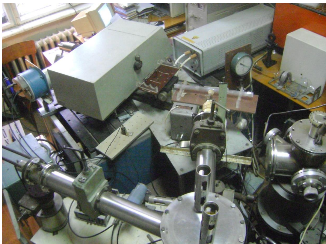
Рис.3.2. Загальний вигляд лабораторної установки для дослідження характеристик УФ-ВУФ ламп із збудженням імпульсно-періодичним ємнісним розрядом.
