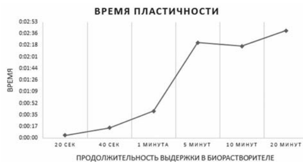
Рис. 10. Время пластичности материала (рабочее время для формирования) во влажной модели костной раны № 2 относительно продолжительности контакта с BioLinker®.
