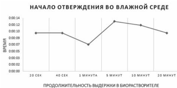
Рис. 8. Время начала отверждения материала во влажной модели костной раны № 2 относительно продолжительности контакта с BioLinker®.
