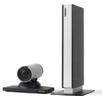
Рисунок 6. Аппаратно-программный комплекс для видеоконференций – терминал с интегрированным кодеком и видекамера. Видеоконференция (синхронная телемедицинская консультация) с использованием аппаратно-программного способа технической реализации по стандарту H.32x (Tandberg Corp.- www.tandberg.com , на рисунке изображена система Edge MXP™)
