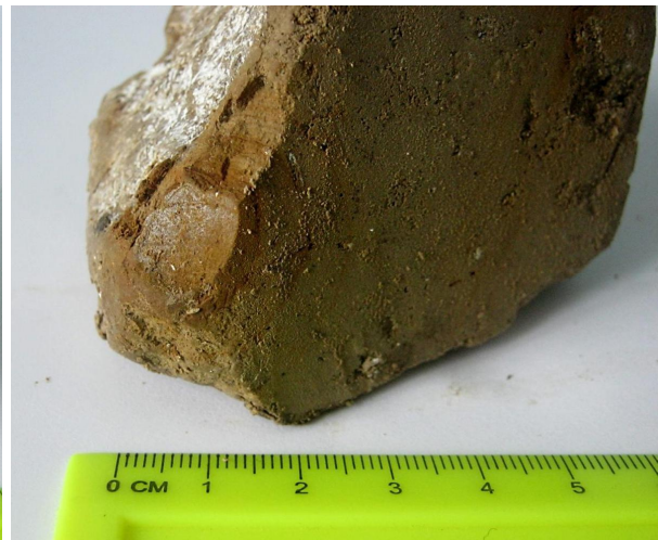
Рис. 5 – Зразок №4: бурі залізисті кільця Лізеґанґа довкола ядра правильної кулястої форми і білий карбонатний наліт у верхньоплейстоценовому лесі. Січень 2018 р. відібрано там само, де зразок №2
