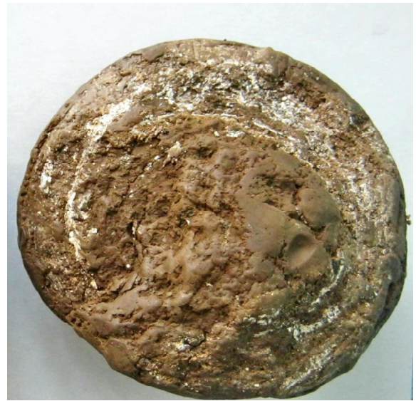
Рис. 2 – Зразок №1: білі карбонатні кільця Лізеґанґа у фрагменті керна (діаметр 110 мм) викопного середньоплейстоценового ґрунту. м. Хмельницький, 2016 р., лівий берег р. Самець
