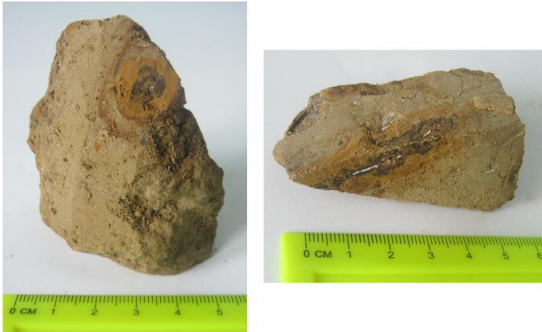
Рис. 3 – Зразок №2: бурі залізисті кільця Лізеґанґа у верхньоплейстоценовому лесі у плані (ліворуч) і у розрізі (праворуч).
