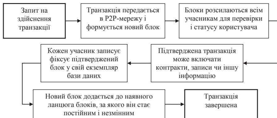
Рис. 1. Узагальнена схема роботи технології блокчейн
