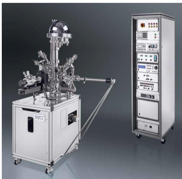
Рис. 2.8. Загальний вигляд установки (Specs GmbH, Берлін, Німеччина) для вимірювання рентгено-фотоелектронних спектрів.
