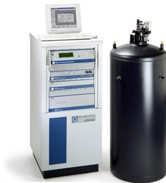
Рис. 2.10. Система вимірювання фізичних властивостей (коефіцієнт теплопровідності) [77].
