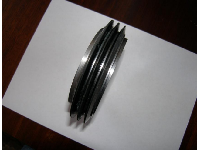
Рис. 1. Загальний вид алмазного червячного хона
