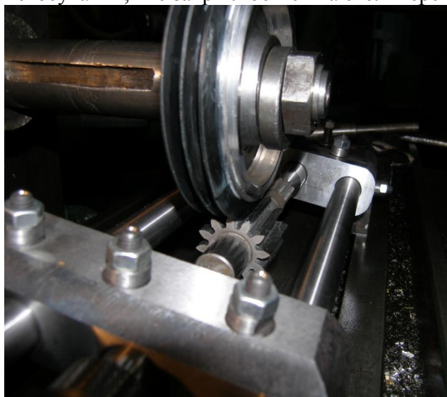
Рис. 2. Робоча зона обробки зубчастих коліс зубохонінгуванням, спеціальне пристосування для обробки і алмазний еластичний черв'ячний
