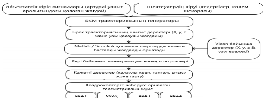
4-сурет. MATLAB-та ағын және сызықты емес реттеуішті басқарудың болжамдық бағдарламасының моделі
