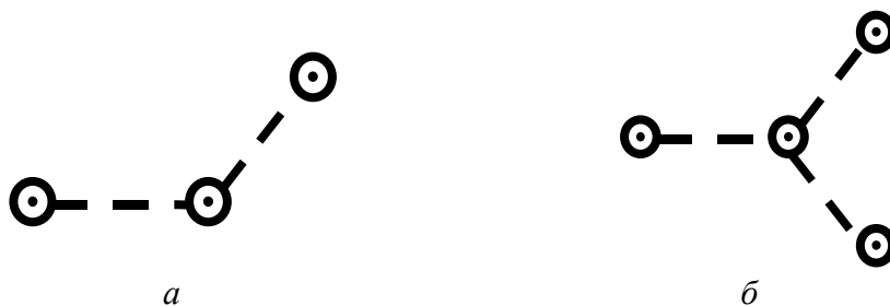
Рис. 3. Схемы расщепления дислокационных ядер типа «крыша» (а) и типа «звезда» (б)
