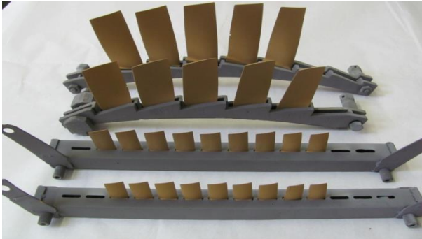
Лопатки 1-й, 2-й, 6-й і 7-й ступенів компресора вертолітного двигуна з семишаровим покриттям \text{TiN/Co}
