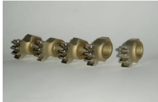
Шестерні з \text{Ti} -сплаву з дифузійним покриттям \text{TiN}
