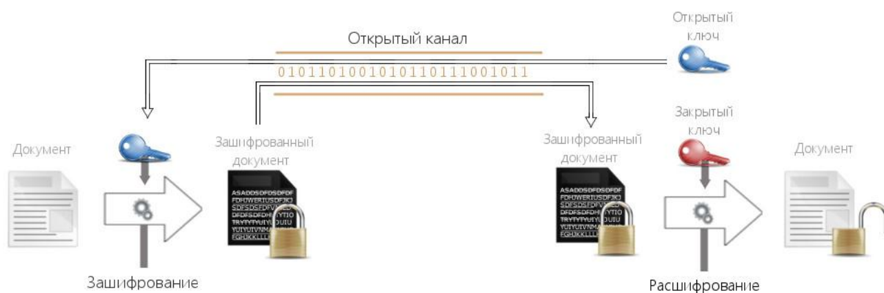
Рис 1. «Принцип асимметричных методов шифрования»
