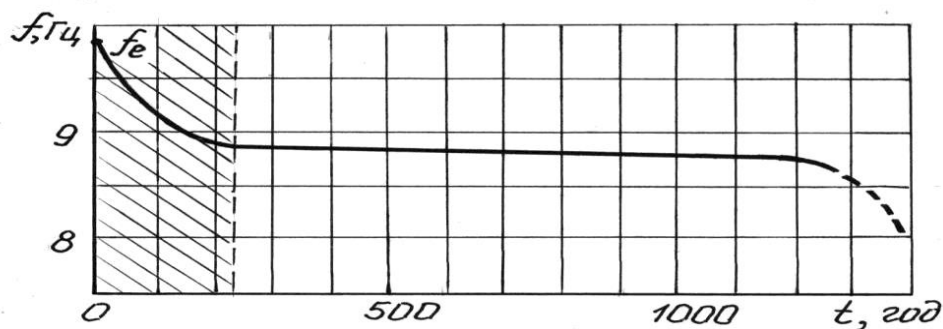
Рис. 2. Графік зміни міцності крила в залежності від часу експлуатації літака
