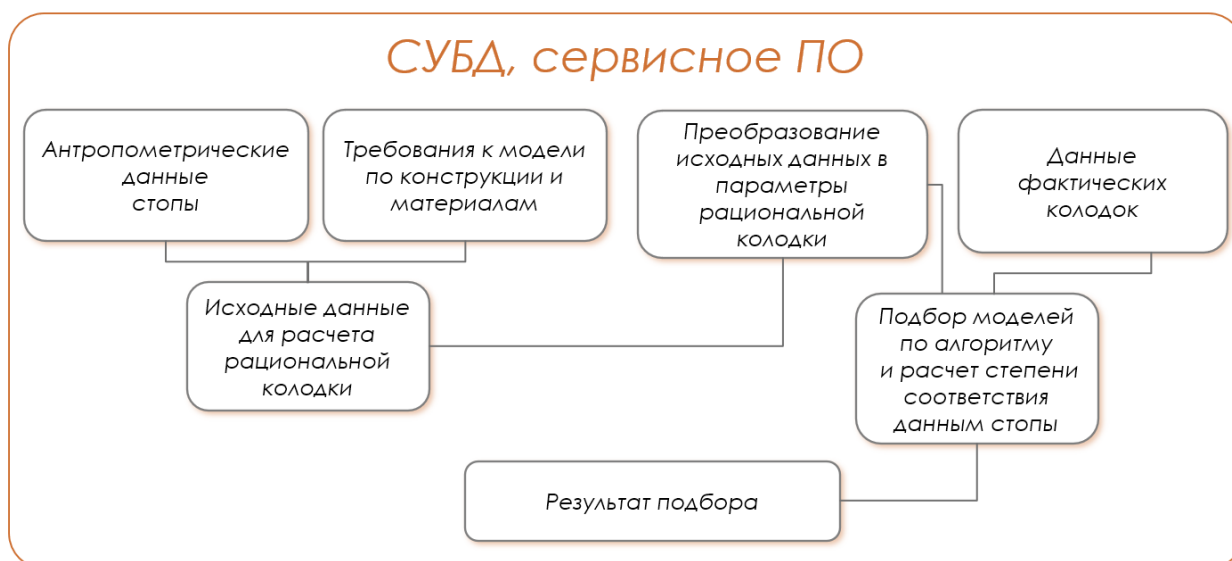
Рис. 1. Концептуальная схема реализации автоматизированного подбора малосложной ортопедической обуви.
