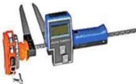
Рис 2. Комп'ютерна мірна вилка Mantax
