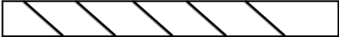
Рис.2. Схема вихревого желоба (арык), интервал между планок более коротче
