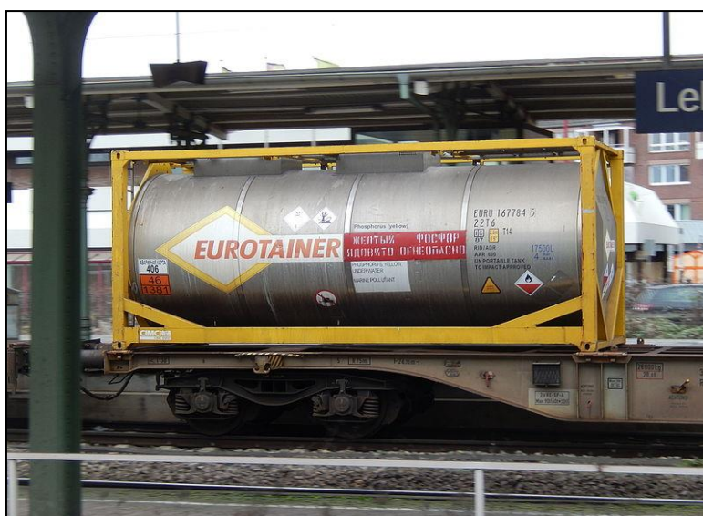
Рис.1. Платформа с контейнером-цистерной для перевозки наливных грузов.
