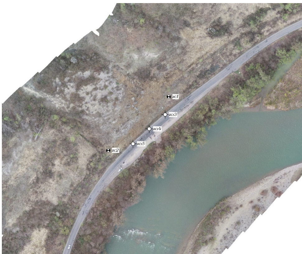
Схема закладання нівелірних знаків (с.Біла Церква)
