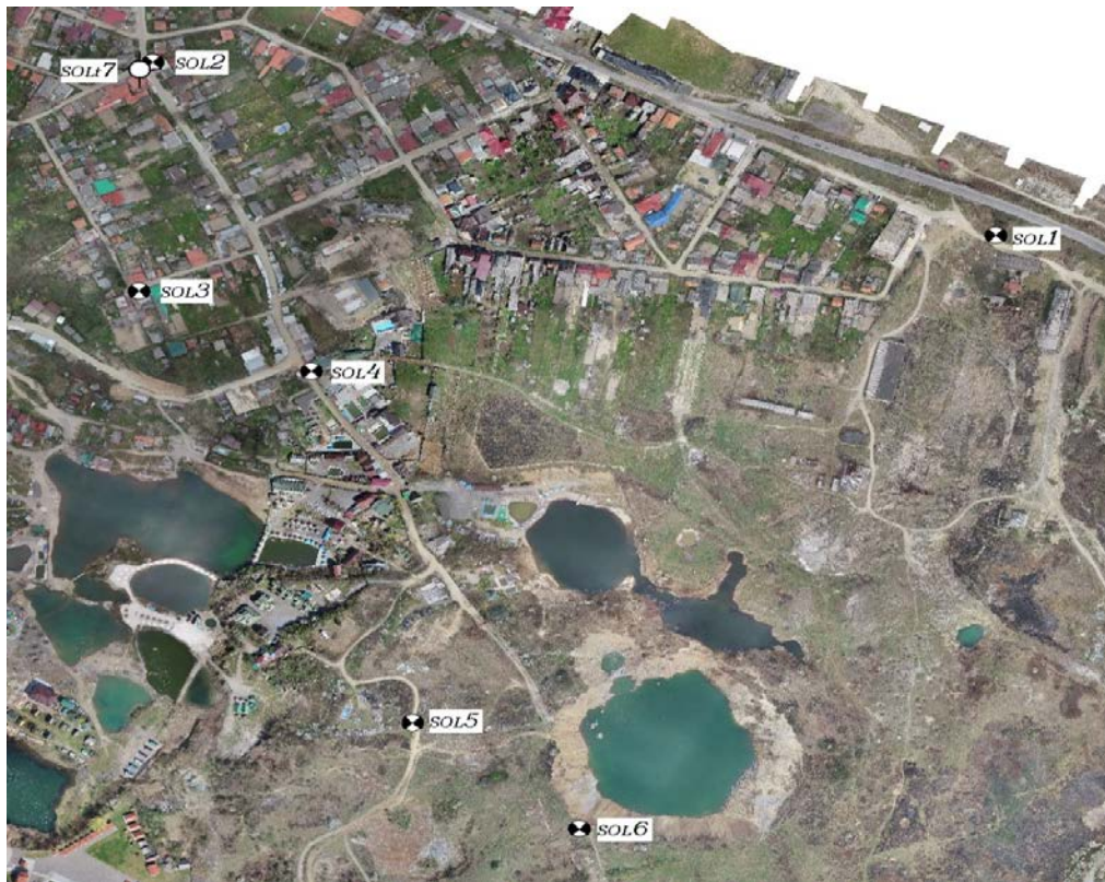
Рис.3.5. Схема закладання нівелірних знаків (об'єкт Солотвино)
