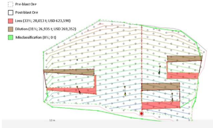
Рис 3. В приведенном примере расчет эффекта показывает, что учет смещения пород при взрыве увеличил бы прибыль более чем на $200 000 за один взрыв.
