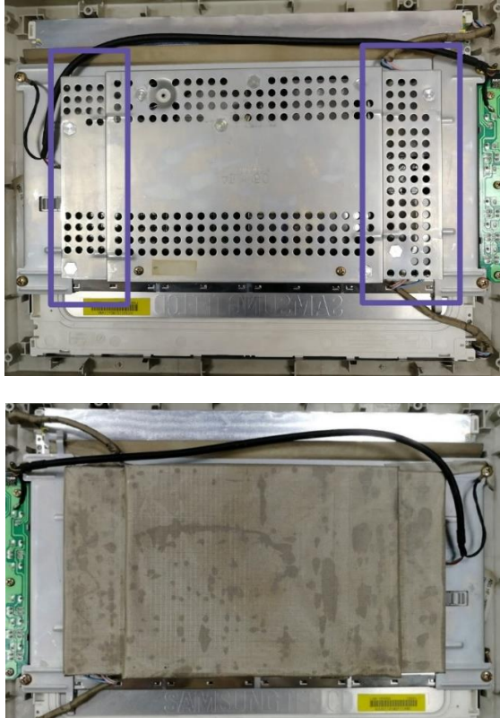
Рисунок 3 – Монитор до экранирования (слева) и после экранирования (справа)
