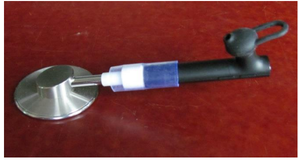
Рис. 1. Гарнітура «Xiaomi Mi Bluetooth Headset» та гарнітура, що встановлена на наконечнику фонендоскопа.
