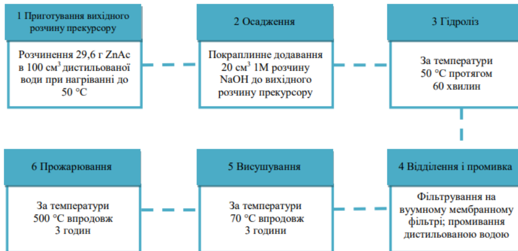
Рис.1 Послідовність стадій лабораторного процесу синтезу цинк(II) оксиду
