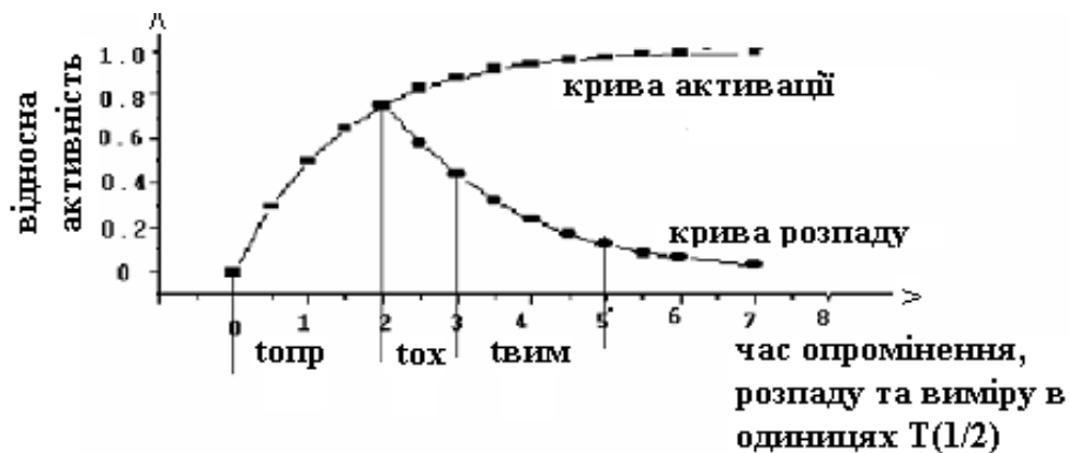
Рис. 1. Зростання активності зразку (кількості радіоактивних ядер) під час опромінення та зменшення активності після припинення опромінення. Поділки по осі абсцис відкладені в одиницях періоду напіврозпаду.
