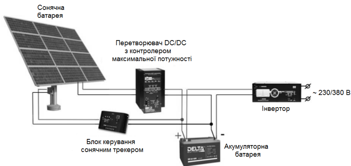
Рисунок 1 – Спрощена схема сонячної електростанції
