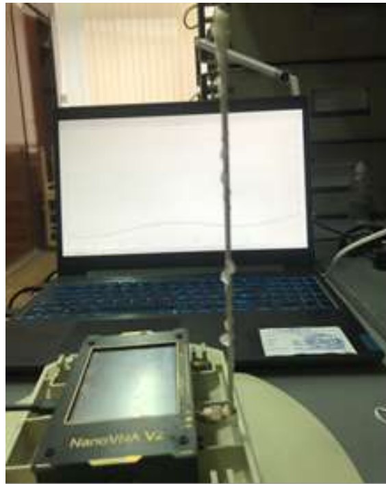
Рисунок 2. Измерение импедансных характеристик штыревой антенны канала управления
