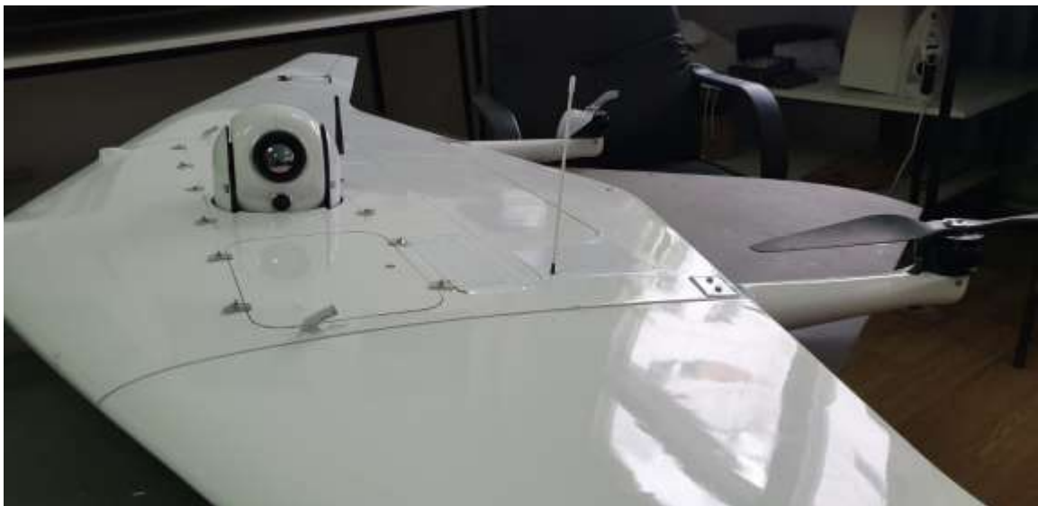
Рисунок 1. Беспилотный авиационный комплекс вертикального взлета «Талисман» компании «СКАЙТОРЕЗ» с установленной на нем штыревой антенны канала управления
