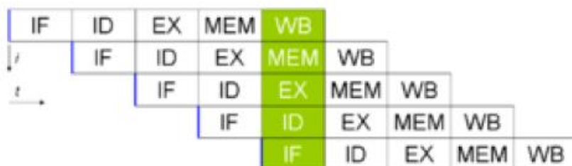
Рис. 2.2. Стандартний п'ятикроковий конвеєр в машині RISC.
