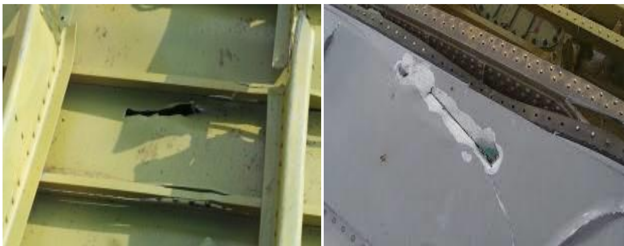
Рис. 5-6. Пробоїни в обшивці крила ЛА без пошкодження силового набору крила
