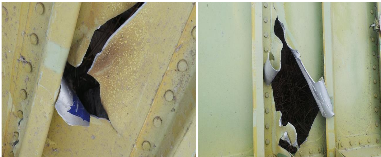
Рис. 3-4. Пробоїни в обшивці крила ЛА з пошкодженням полок силових стрингерів
