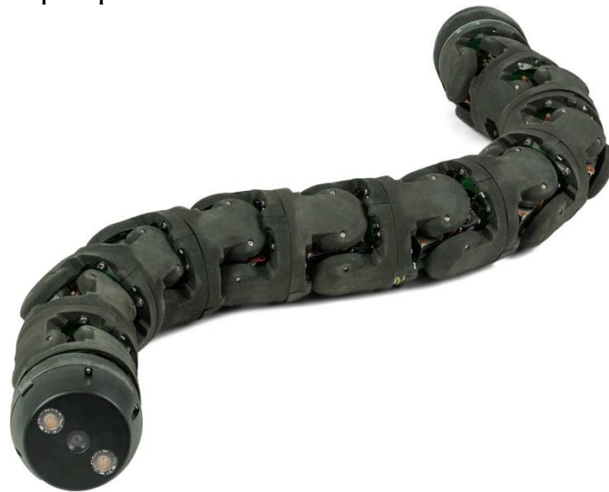
Рисунок 2 - Змееподобный многозвенный робот «Змеелок-1»
