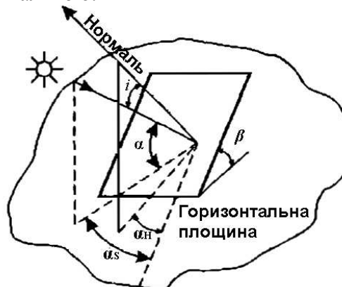
Рис. 3. Кути, які характеризують положення точки на похилій поверхні відносно напрямку сонячних променів
