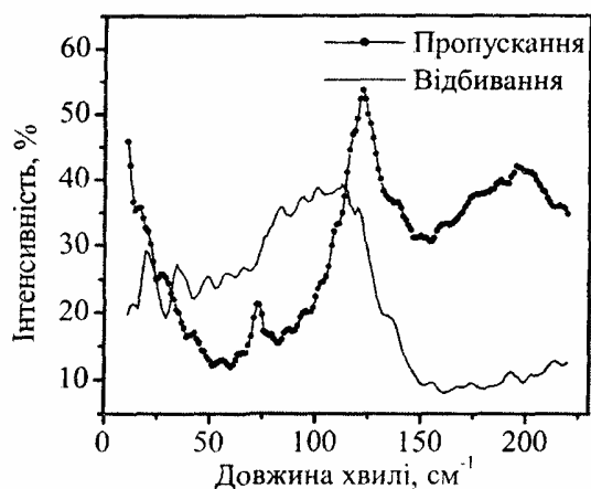
Рис. 1. ІЧ спектри пропускання і відбивання кристала 4H\text{-CdI}_2 .
