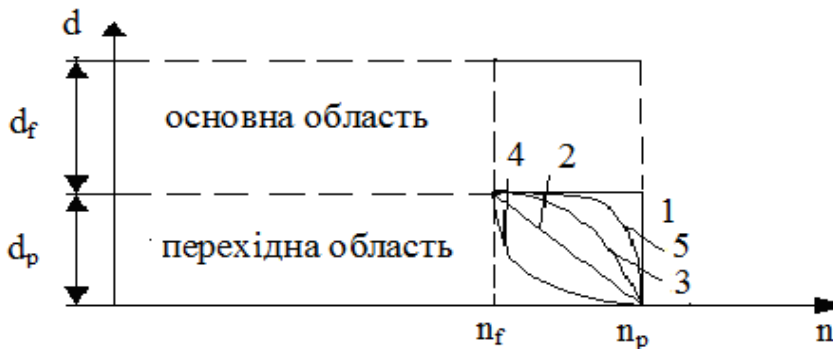
Рисунок 1 – Модель профілю показника заломлення частково неоднорідної плівки (розподіли показника заломлення: 1 – ступінчатий; 2 – лінійний; 3 – квадратичний; 4 – логарифмічний; 5 – експоненціальний)
