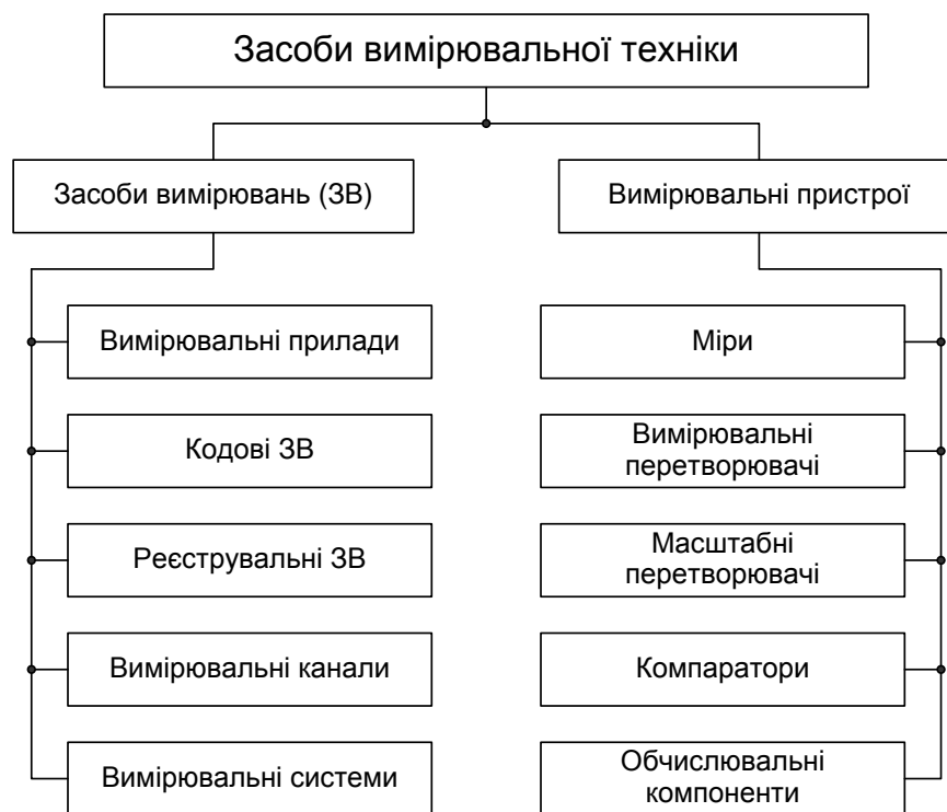
Рис.3.1. Класифікація засобів вимірювальної техніки
