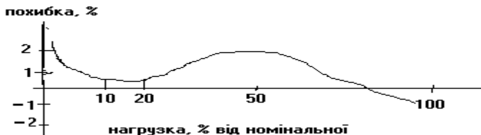
Рис. 6.2. Залежність похибки електричних лічильників від зміни нагрівки.
