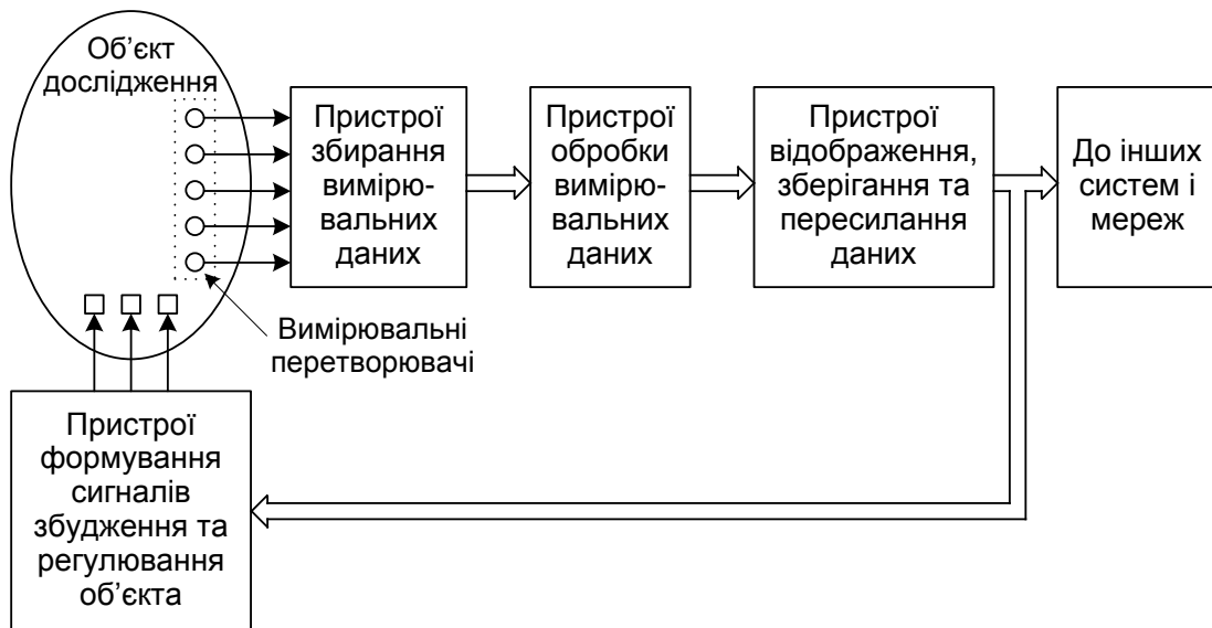
Рис. 3.6. Функціональні пристрої вимірювальної системи
