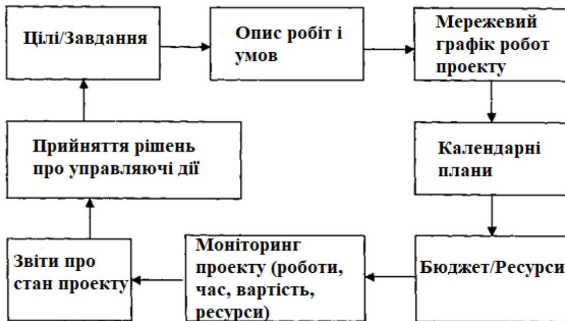
Рис. 4.2. Схема процесу управління проектами
