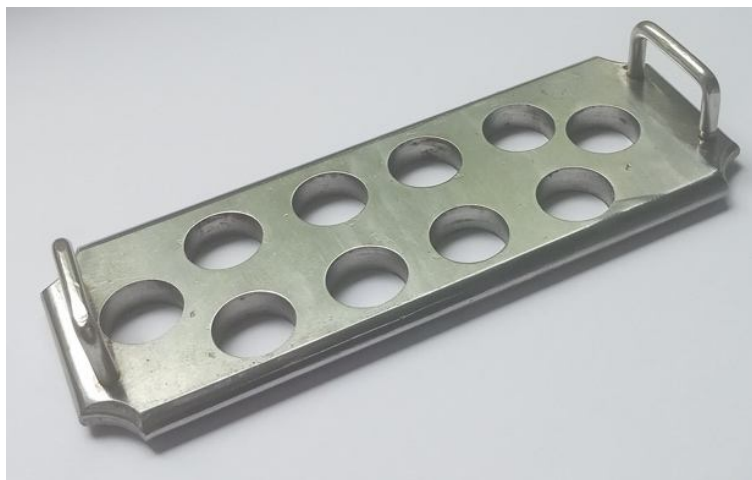
Рис. 1. Конструкція форми (а) для виготовлення дискових зразків зі стоматологічних композитів та її загальний вигляд (б)
