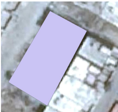
Рис. 4.16. Приклад векторизованої пошкодженої ділянки будинку
