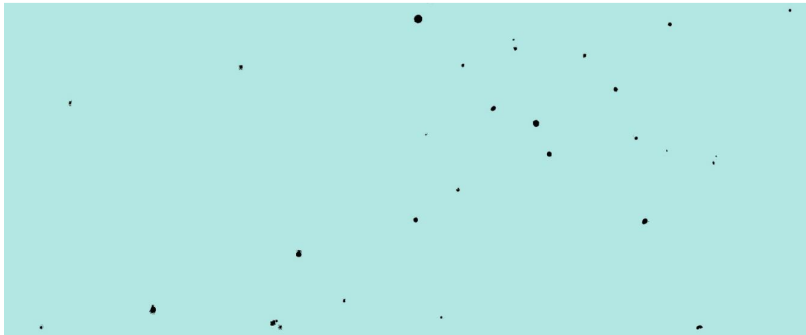
Рис. 3. Мікроструктура полірованих нетравлених зразків, наплавлених порошковими дротами ПП-Нп-120В3ХМФ(л) (а) і ПП-Нп-120В3ХМФ (фс)
