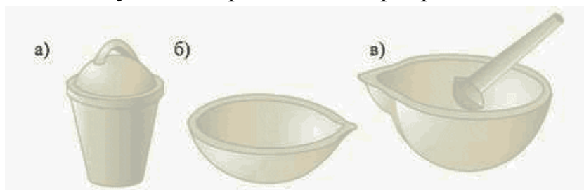
Рис. 4. Фарфоровий посуд: а) тигель; б) чашка для випаровування; в) ступка з товкачиком
