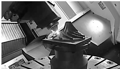
Рис. 1. Обробка деталі на машині DMG Lastertec 65 3D Hybrid
