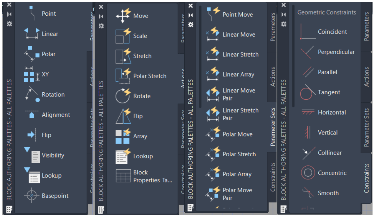
Рис.34. Палітри варіацій блоків: a – параметри, б – операції, в – набори параметрів, г – залежності
