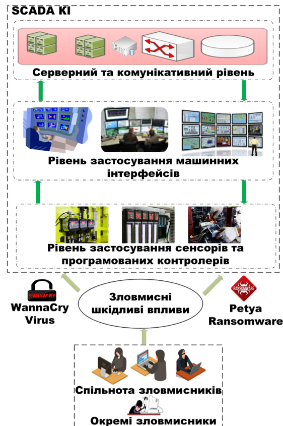
Рисунок 2 – Схема реалізації ЗВШВ на активи SCADA KI
