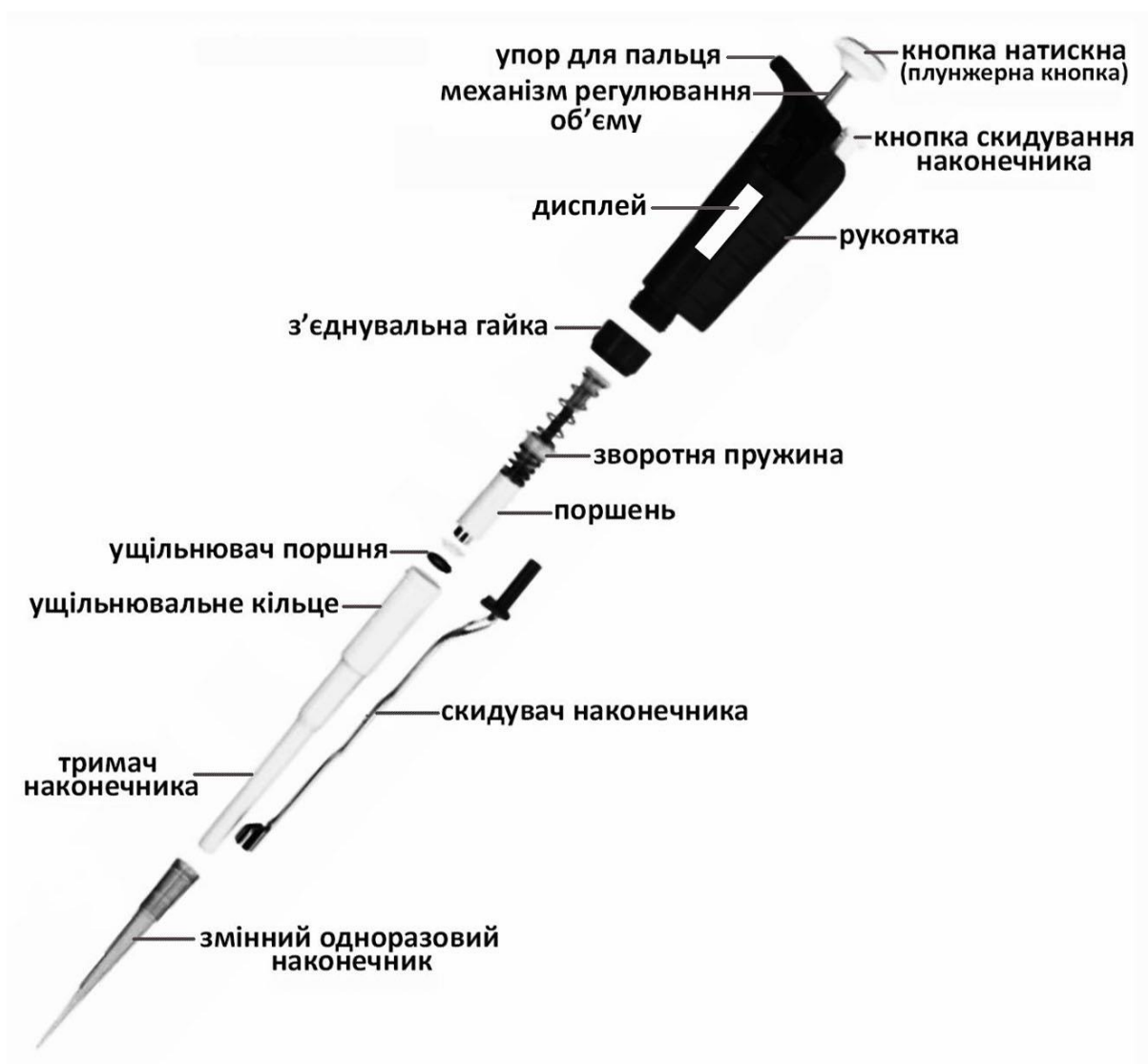
Рис. 1.2. Схема будови одноканального піпеточного дозатора у розібраному вигляді.
