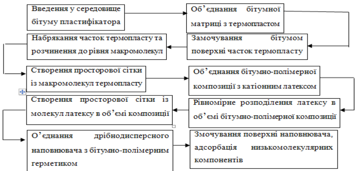
Схема 1. Схема процесу об'єднання складників бітумно-полімерної герметизуючої мастики шляхом перемішування
