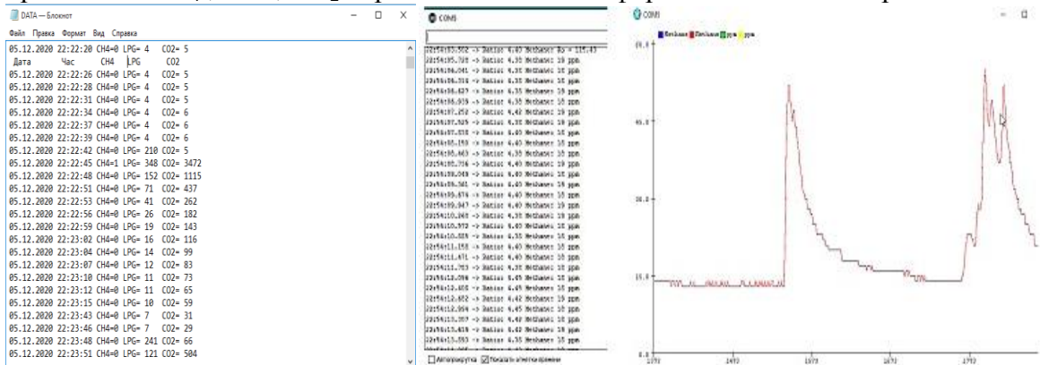
Рис. 9. Вимірювані дані записані на SD – картку, та відображення результатів вимірів концентрації газу з датчика MQ-4 на плоттері та моніторі послідовного порту.
