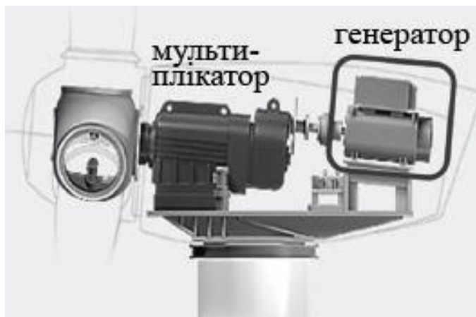
Рис. 11.7. Схема з'єднання валу вітроколеса, мультиплікатора і генератора
