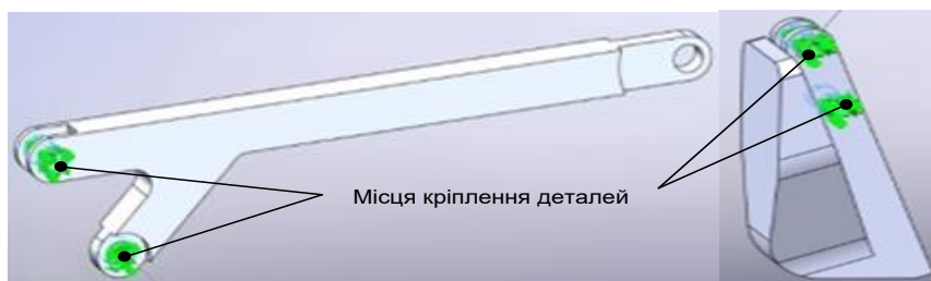
Рис. 2. Місця кріплення штанги та контактної опори
