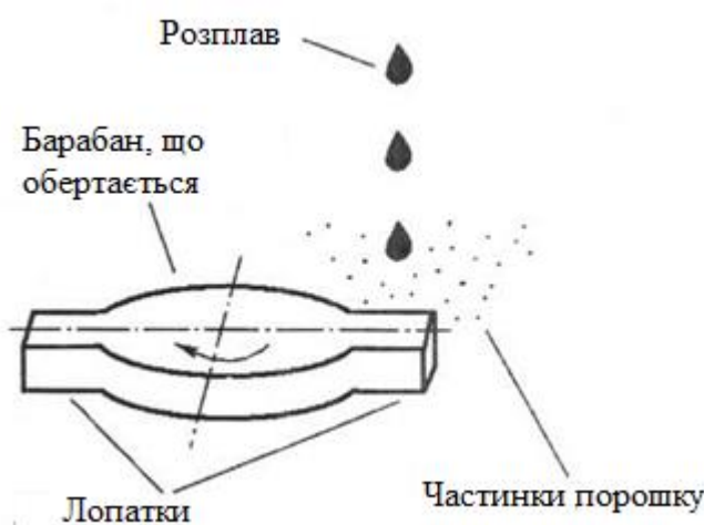
Рис. 6.12. Принципова схема процесу ударного розпилення розплаву
