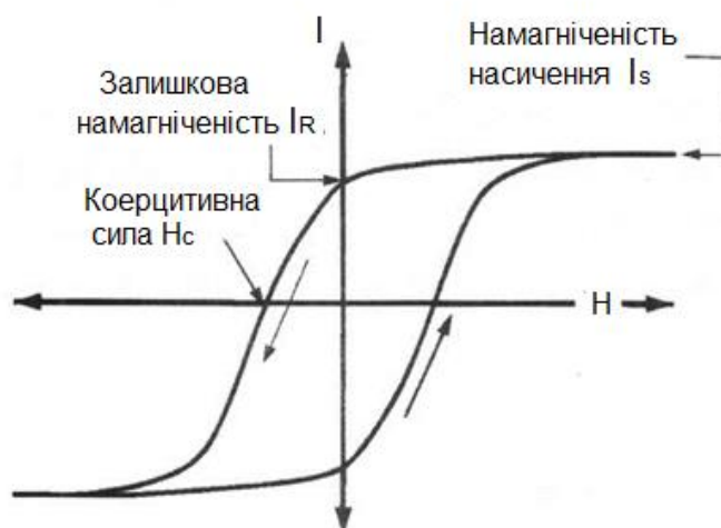
Рис. 4.30. Крива намагнічування феромагнітного матеріалу та її основні параметри:
