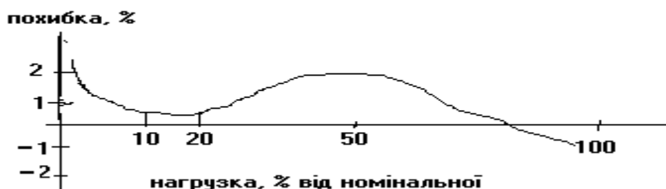
Рис. 6.2. Залежність похибки електричних лічильників від зміни нагрівки.
