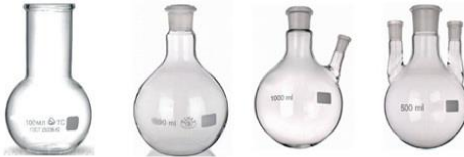
Рис. 4. Колби з плоским та круглим дном: плоскодонна звичайна, плоскодонна зі шліфом, круглодонна з двома горловинами зі шліфом, круглодонна з трьома горловинами зі шліфом.
