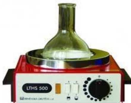
Рис.51. Водяна баня з регулятором рівня води.
