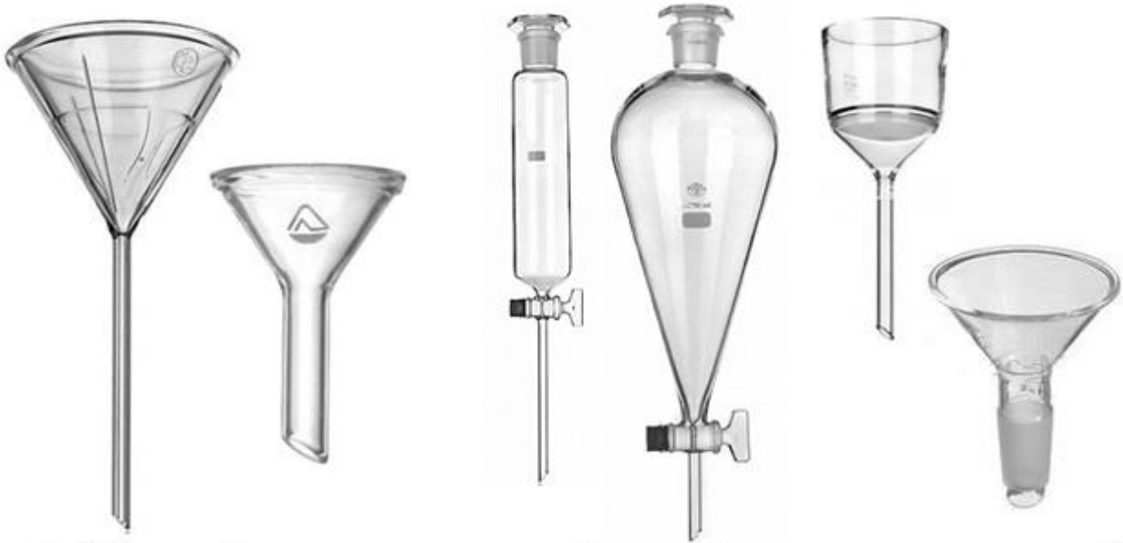
Рис. 3. Лійки: лабораторна з довгим стеблом, лабораторна з коротким стеблом, дільна циліндрична зі скляним краном, дільна грушоподібна з тефлоновим краном, фільтруюча з пористим диском без шліфа, фільтруюча з пористим диском зі шліфом.
